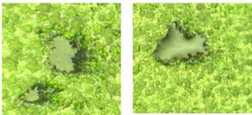
Abbildung 3: Beschädigungen der Druckplatte unter Digitalmikroskop (Zoom: 700x)
